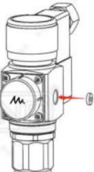
Umístěte malé bílé těsnění do otvoru regulátoru a položte ho na dno.
