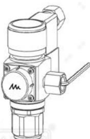
Namontujte součástku na výstup regulátoru a přišroubujte ji pomocí dodaného šestihranného nástroje - imbusu, abyste zajistili, že plyn nebude unikat okolo.
